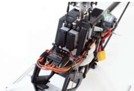
Spektrum AR7200BX receiver/BeastX controls the Spektrum H5010 mini servos
